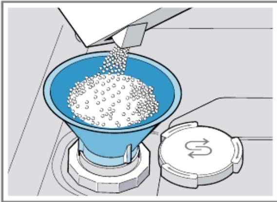
Den Vorratsbehälter komplett mit Spezi­alsalz füllen. Das Wasser im Vorrats­behälter wird verdrängt und läuft ab.
