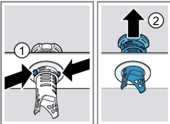
5. Unter fließendem Wasser die Siebelemente reinigen.
